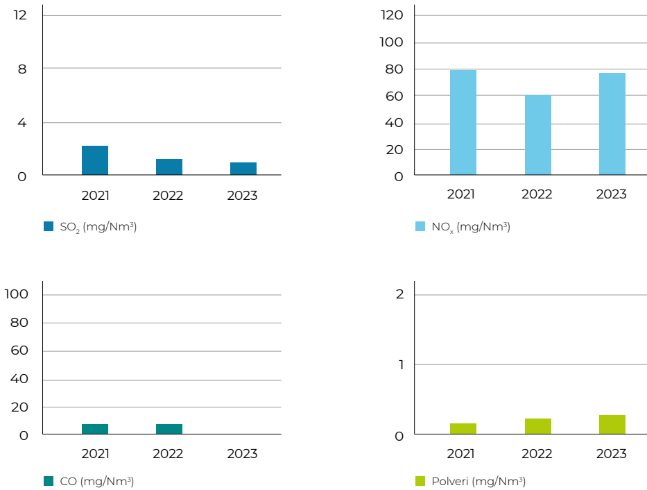
Fig. 3.5.3 - Valori medi annuali delle concentrazioni delle emissioni da TG01/B01 di CTE**
